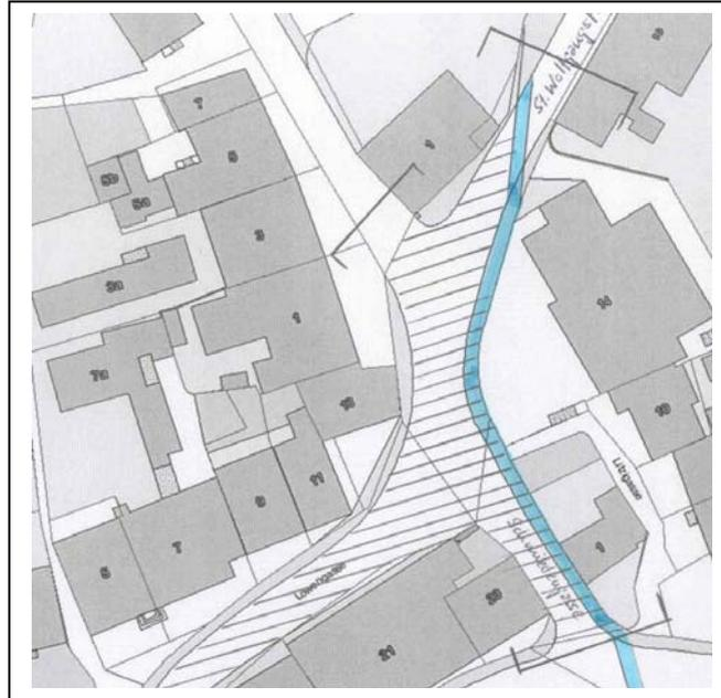
Die Deckenplatte der Eindolung Steinenbach an der St. Wolfgangstrasse und Schmiedengasse ist in einem schlechtem Zustand. Gleichzeitig werden im Bereich der St. Wolfgangstr. / Schmiedengasse / Löwengasse die Wasser- und Elektroleitungen erneuert. Nach Abschluss dieser Arbeiten wird der Strassenbelag im genannten Abschnitt ersetzt.
